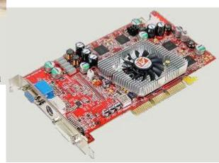
un conector **HD15**, que a veces se denomina **VGA**, azul, de 15 pines en tres filas, para el cable de la pantalla. Algunos conectores que se utilizan para conectar un dispositivo al ordenador se suelen llamar **puertos**. Genéricamente, un puerto es cualquier interfaz que se utilice para transmisión de datos (enviar o recibir).
