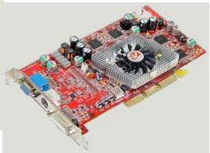
de los cálculos y liberan al micro de ese trabajo. Esto produce un aumento del rendimiento. El slot o conector es de color marrón (aunque en la figura aparece en color verde claro). Lleva un mecanismo para enganchar bien la tarjeta.
